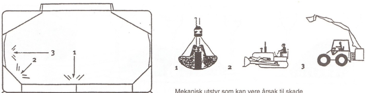
Mekanisk utstyr som kan vere årsak til skade
